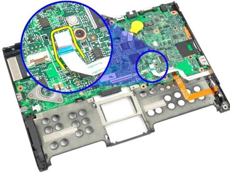
17. Løft clipsen, der holder SATA-kablet fast.
